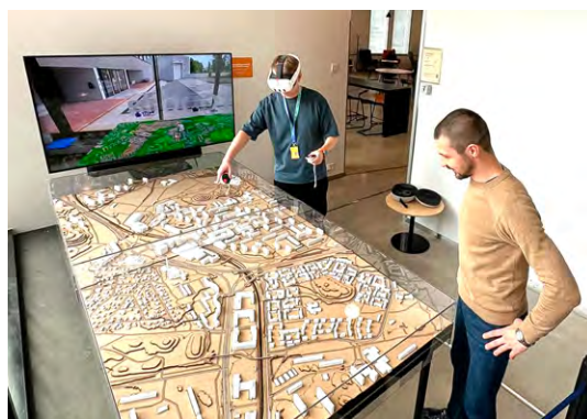
Kuva 2. Myllypuron AR-demonstraatiomalli käytössä Meta Quest 3 -laseilla. Fyysinen pienoismalli ja digitaalinen kerros sulautuvat käyttäjän näkökentässä yhtenäiseksi kokonaisuudeksi, joka näkyy myös mallin takana olevalla näytöllä. Näkymä havainnollistaa lisätyn todellisuuden (AR) perusidean: todellinen ympäristö ja digitaalinen sisältö koetaan samanaikaisesti päällekkäin. Kuva: Eunice Siame-Moono.
